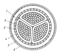
Поперечный разрез трехжильного силового кабеля
