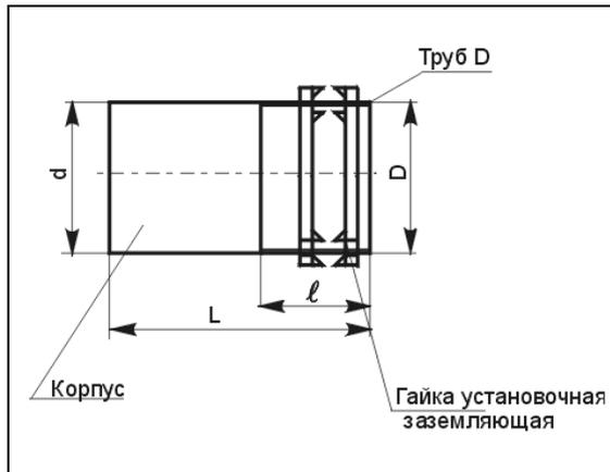
Предназначены для ввода проводов и кабелей в оболочку электротехнических изделий при выполнении электропроводок с применением металлорукавов и стальных труб, не имеющих резьбы. Патрубки соединяются с трубами муфтами ТР. Изготавливаются патрубки из стали с металлическим покрытием.
