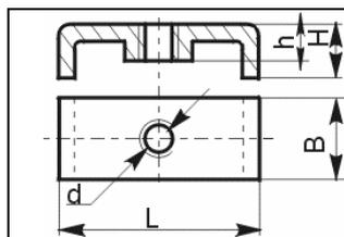
Предназначены для крепления аппаратов, кабелей, проводов и труб с С-образным профилем. Изготавливаются из стали с гальваническим покрытием. ТУ 36-1953-80
