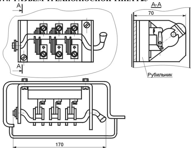
Предназначен для использования в целях вторичной коммутации камер КСО-266.
