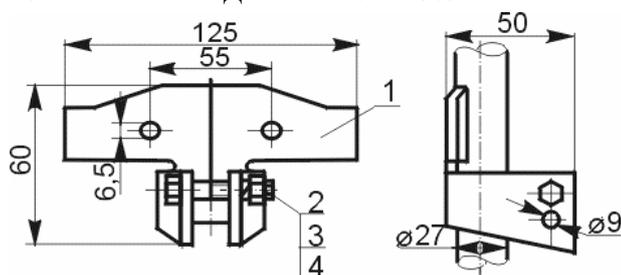
Предназначен для установки кронштейнов К986 на стенах или колоннах, а так же для крепления диаметром 3/4" на различных основаниях. Изготавливается держатель из стали с лакокрасочным покрытием.
