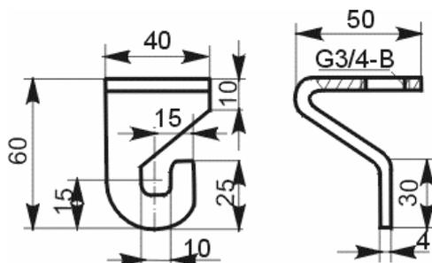
Предназначен для закрепления светильников массой до 15 кг на подвесах трубчатых К980—К983 и массой до 12 кг на стойках и кронштейнах. Изготавливается держатель из стали с металлическим покрытием.
