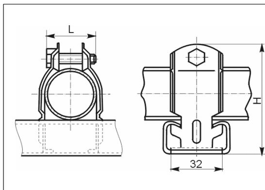
Предназначены для крепления труб и кабелей к С-образным профилям при выполнении электромонтажных работ.
