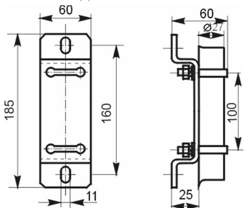
Предназначен для установки кронштейнов К986 на стенах или колоннах. Изготавливается держатель из стали с лакокрасочным покрытием. Виды климатических исполнений изделия УЗ и ТЗ по ГОСТ 15150-69. ТУ36-1459-82.
