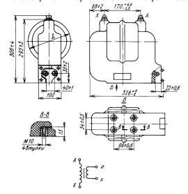
Рис. 1. Габаритные, установочные и присоединительные размеры трансформатора напряжения (размер Д для НОЛ.08-6 составляет. 188 - 2,9 мм, для НОЛ.08-10 - 212-2,9 мм; диаметры резьбы вводов А и X - M10, вводов а и x - M6; максимально допустимые толщина шин и диаметры проводов, присоединяемых к трансформаторам, для вводов А и X - 10 мм, для вводов а и X - 3 мм).
