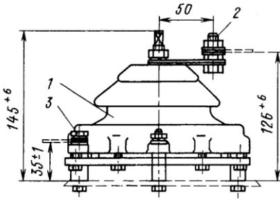
Габаритные, установочные и присоединительные размеры ограничителей перенапряжений типов ОПН-0,64 УХЛ2, ОПН-1,23 УХЛ2, ОПН-1,28 УХЛ2
